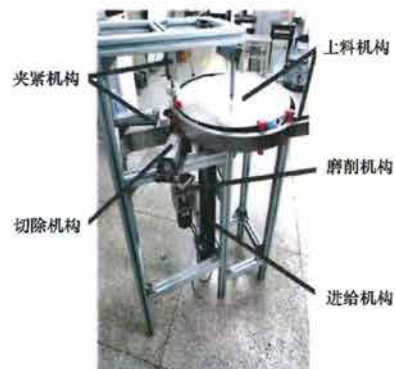
图5 印章胚料数控切磨机机械结构图
